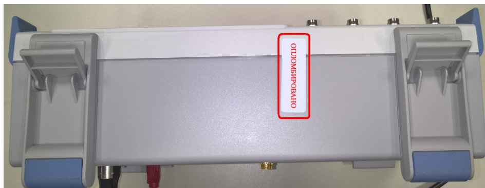
Рисунок 4 – Схема пломбировки от несанкционированного доступа (вид снизу)
