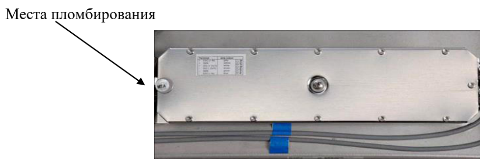
Рисунок 6 – Место пломбирования АЦП ГПУ
