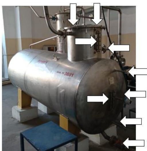
Рисунок 2 – Схема пломбировки мерника МТ-ГИЦ-250Н, зав.№ 18-76 от несанкционированного доступа, обозначение места нанесения знака поверки
