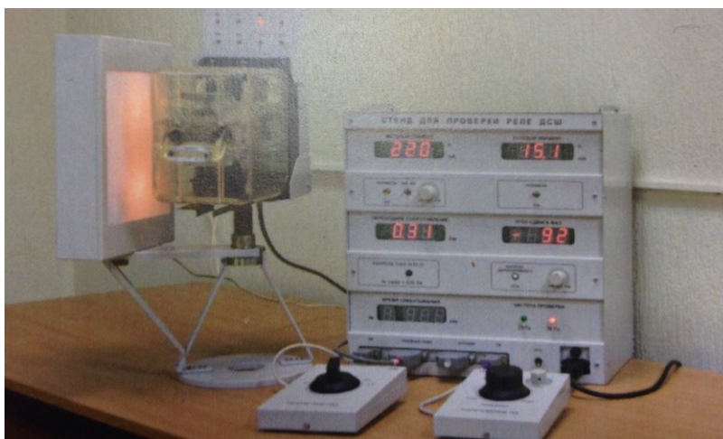
Рисунок 1 - Общий вид стандов проверки параметров двухсекторных тепсельных реле «ДСШК»
