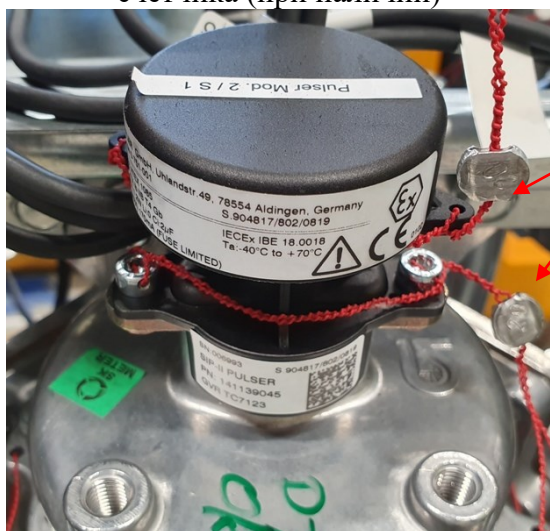
е) Схема пломбировки датчика импульсов SIP-II
