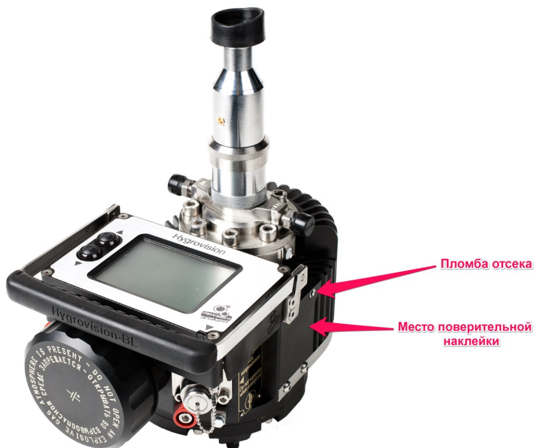
Рисунок 1 - Внешний вид анализатора точки росы «Hygrovision-BL»
