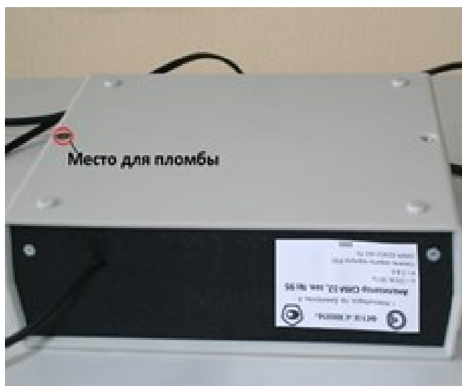
Рисунок 2 - Схема пломбировки от несанкционированного доступа
