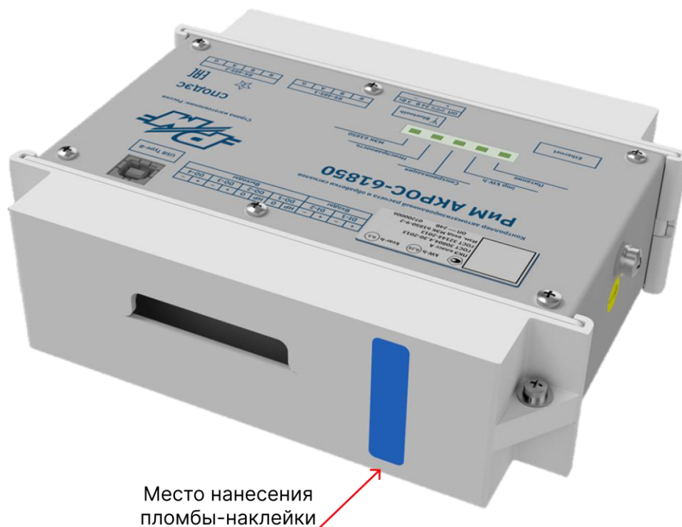
Рисунок 6 – Место нанесения контрольной пломбы-наклейки на кожух защитный АКРОС для защиты от несанкционированного доступа к разъемам дискретных входов/выходов (устанавливаются при необходимости)
