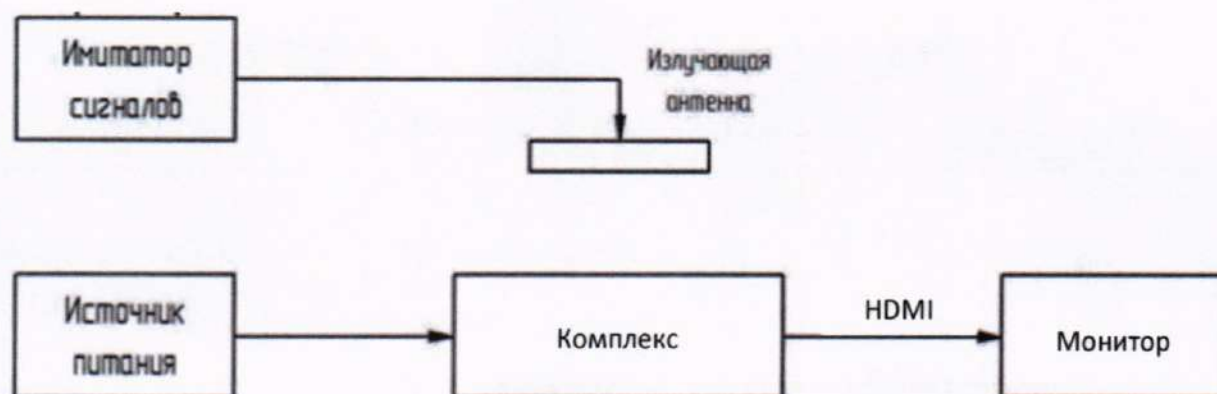
Рисунок 1. Схема подключения имитатора ГНСС к комплексу
