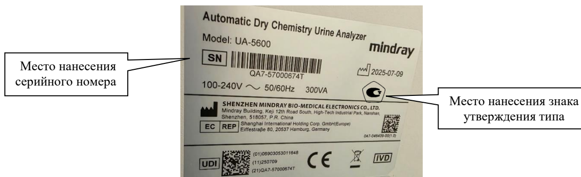
Рисунок 2 - Места нанесения серийного номера и знака утверждения типа.
