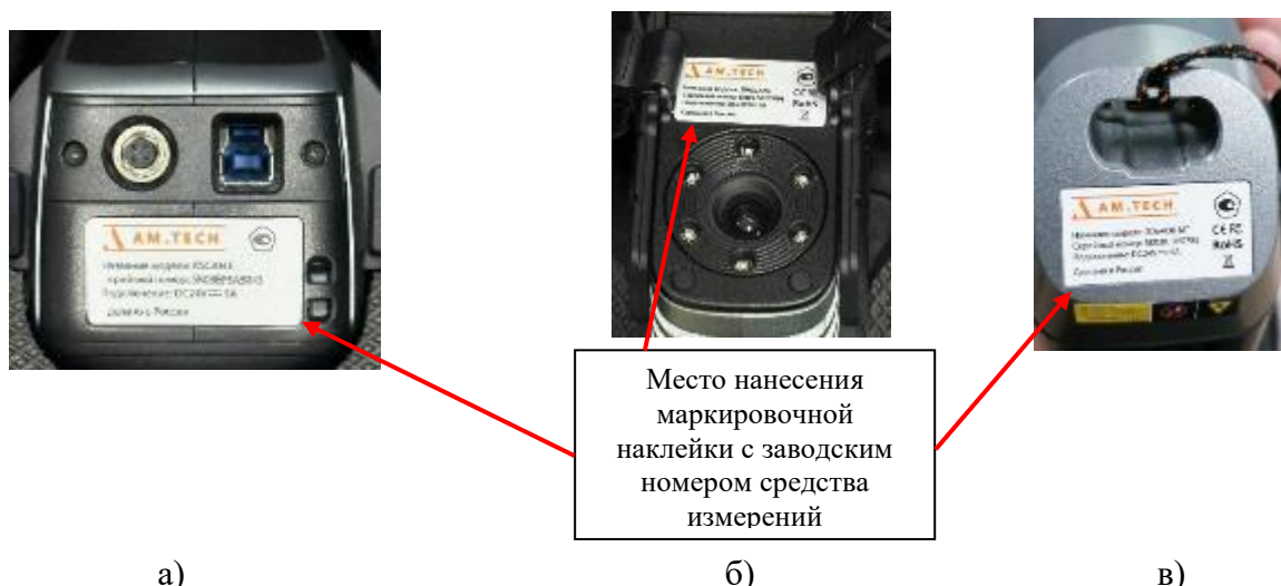
Рисунок 2 – Место расположения маркировочных наклеек с указанием заводского номера приборов оптических координатно-измерительных бесконтактных AM.TECH LaserSCAN модификаций:
