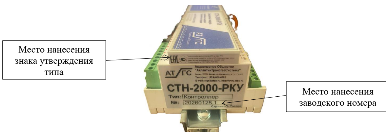
Рисунок 2 – Общий вид модулей ЦПУ из состава контроллеров
