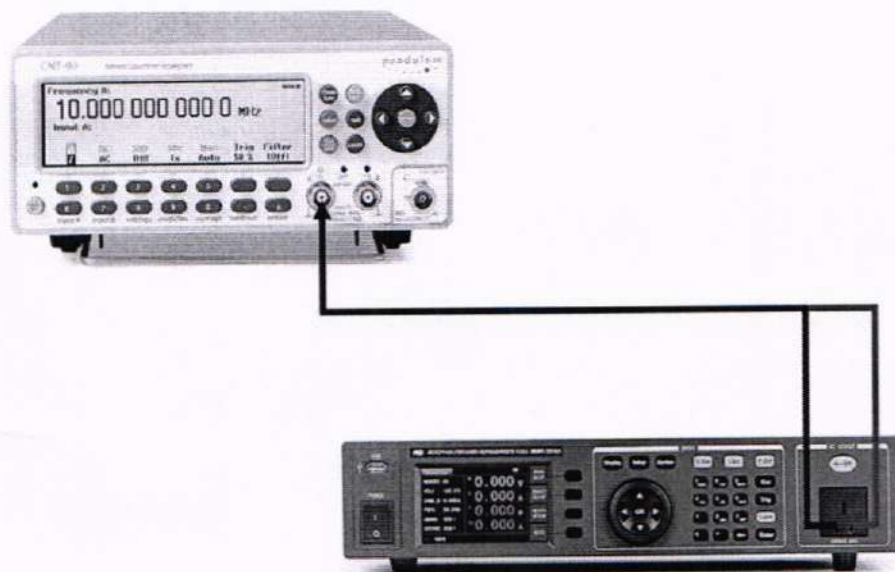
Рисунок 2- Схема соединения приборов для определения параметров частоты источников
