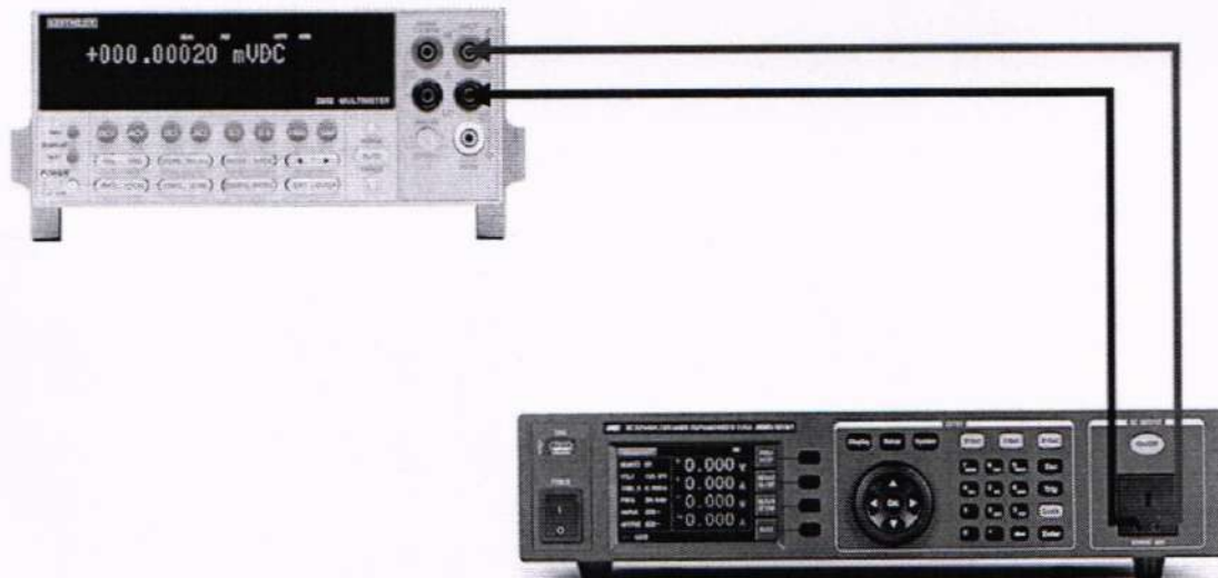
Рисунок 1 – Схема соединения приборов для определения параметров выходного напряжения источников
