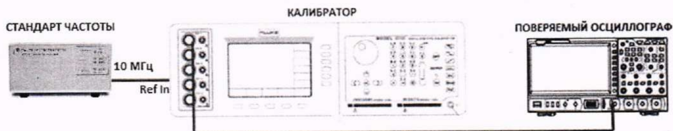
Рисунок 2 – Схема подключения оборудования для определения полосы пропускания, абсолютной погрешности измерения временных интервалов
