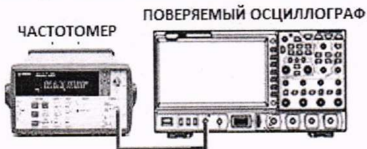
Рисунок 5 – Схема подключения оборудования при определении относительной погрешности установки частоты выходного сигнала генератора
