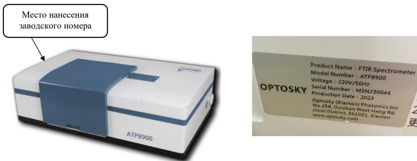
Рисунок 1 – Спектрометры модификации ATP8900, обозначение места нанесения заводского номера, вид таблички с нанесенным заводским номером
