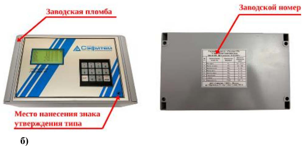
Рисунок 2 – Общий вид газоанализаторов Геолан-1П: а) исполнение в пластиковом корпусе; б) исполнение в корпусе из алюминиевого сплава
