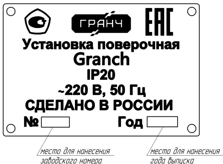
Рисунок 3 – Общий вид шильда с указанием места нанесения заводского номера и нанесенным знаком утверждения типа
