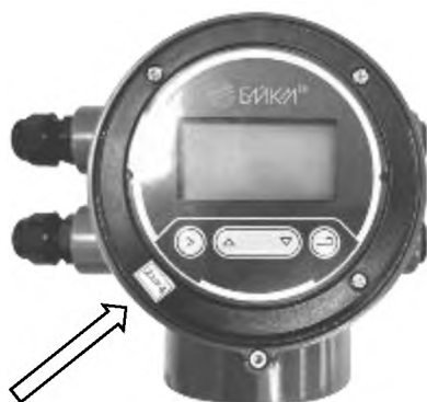
Рисунок 4 – Схема пломбировки от несанкционированного доступа, обозначение места нанесения знака поверки расходомеров
