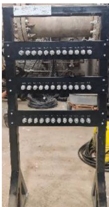
Рисунок 7 – Панель пневматической коммутации. Вид общий
