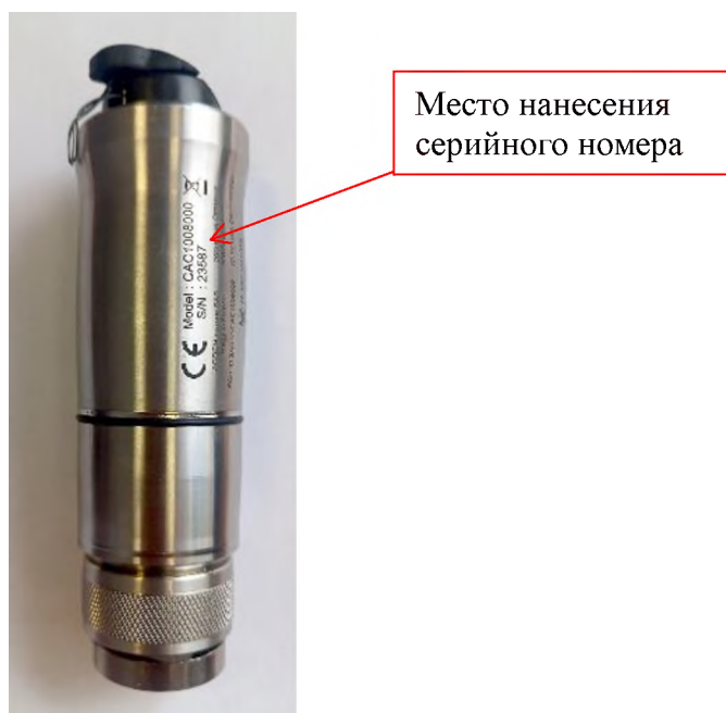
Рисунок 2 – Общий вид систем виброизмерительных беспроводных VT-300
