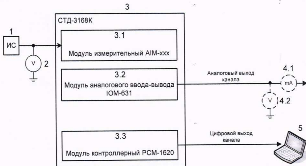
Рисунок 6 - Схема подключения системы для определения основной приведенной погрешности измерений постоянного (статического) смещения (зазора, сдвига) измерительного прибора (измерительной цепи) для каналов с входом по напряжению
