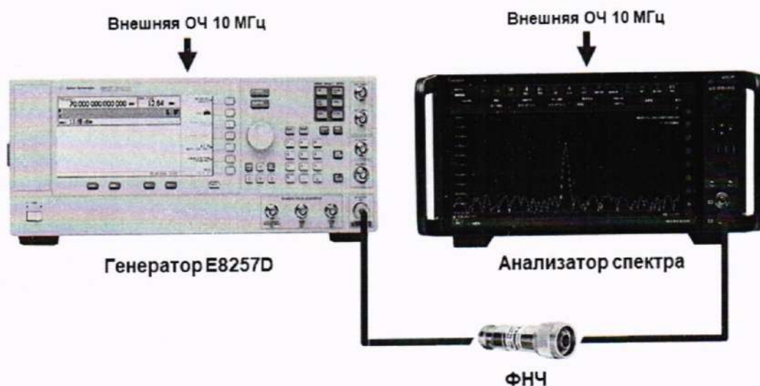
Рисунок 8. Схема соединения приборов для определения уровня гармонических искажений 2-го порядка
