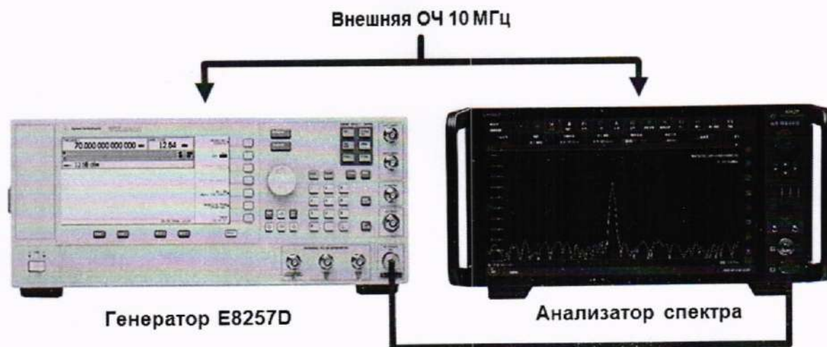
Рисунок 4. Схема соединения для определения погрешности измерения уровня при переключении аттенюатора относительно 10 дБ.
