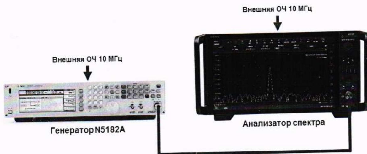
Рисунок 10. Схема соединения приборов для определения остаточного среднеквадратического значения векторной ошибки модуляции
