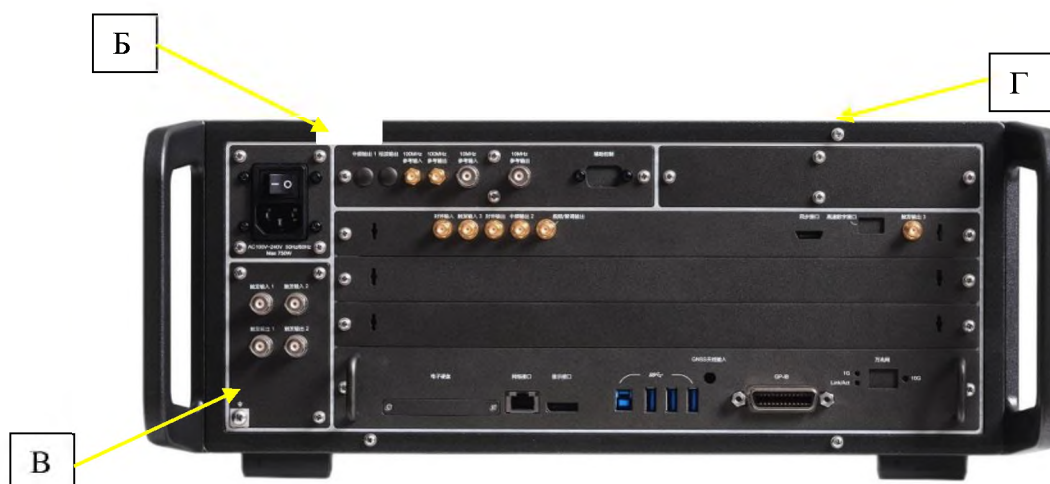
Рисунок 2 – Схема пломбировки от несанкционированного доступа (Б), место нанесения серийного номера (В) и знака поверки (Г)
