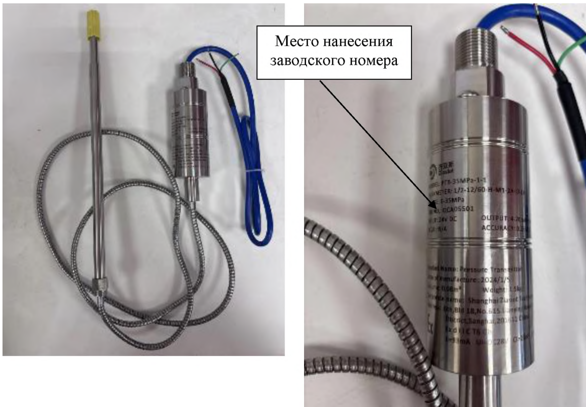
Рисунок 1 – Общий вид преобразователя давления расплава измерительный РТВ и место нанесения заводского номера
