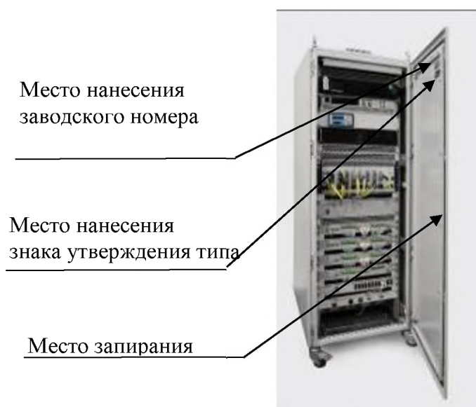
Рисунок 1 – СИИ ИПТК. Комплекс управления и измерения, источник бесперебойного питания, ethernet-коммутатор, ЭВМ СП, смонтированные в стойке приборной
