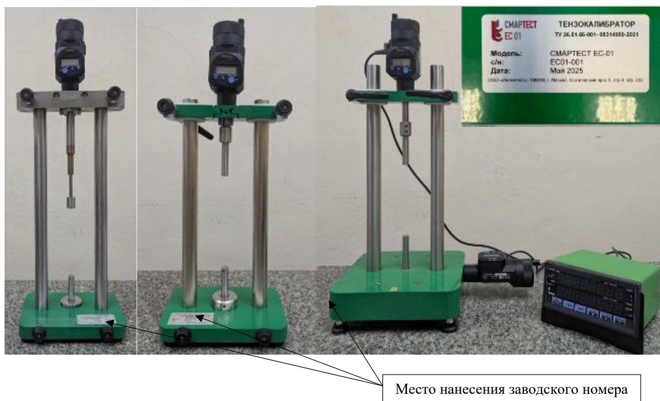
Рисунок 1 – Общий вид тензокалибраторов СМАРТЕСТ и содержание маркировочной таблички
