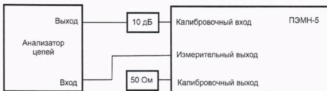
Рисунок 9.2 - Схема проведения измерений коэффициента передачи S_{21} пробников электромагнитных наводок для проведения специальных исследований ПЭМН-5
