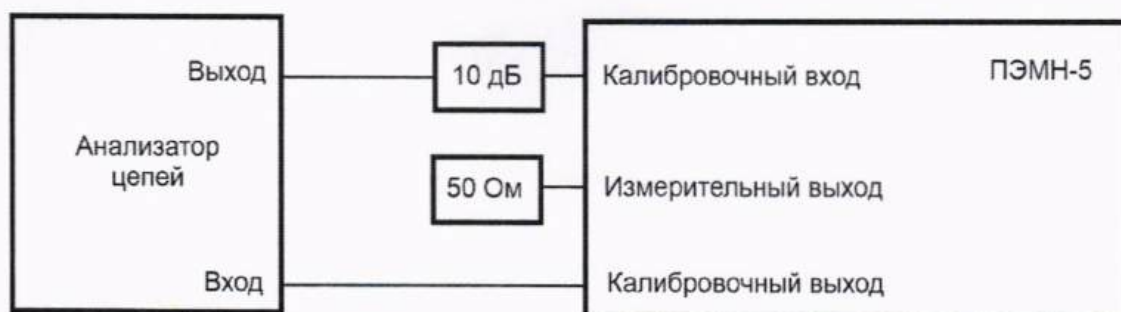
Рисунок 9.1 - Схема для проведения процедуры калибровки анализатора цепей для проведения измерений коэффициента передачи S_{21} пробников электромагнитных наводок для проведения специальных исследований ПЭМН-5
