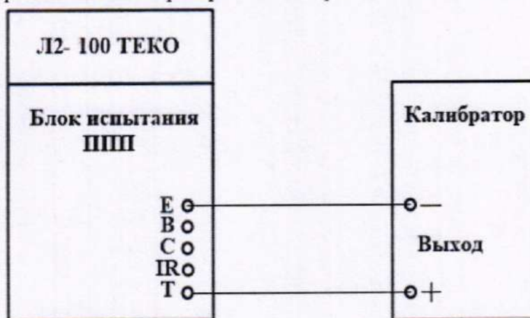
Рисунок 4 - Схема измерения тока коллектора
