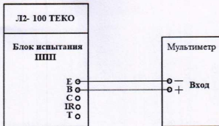
Рисунок 6 - Схема измерения величины размаха ступенчатого тока и напряжения базы, а также величины тока и напряжения смещения базы
