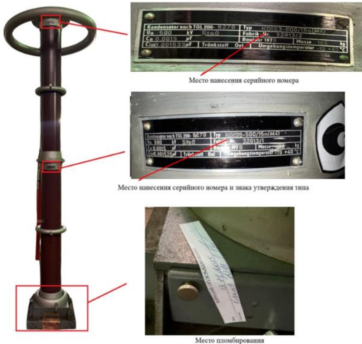
Рисунок 1 – Общий вид делителя напряжения ёмкостного SMC 750/1000 с указанием мест пломбирования от несанкционированного доступа, нанесения серийного номера и знака утверждения типа
