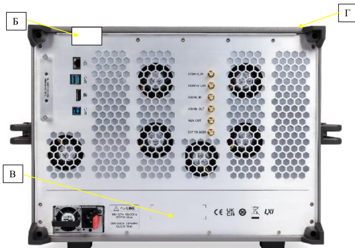
Рисунок 2 – Вид задней панели осциллографов, место пломбировки от несанкционированного доступа (Б), место нанесения серийного номера (В) и знака поверки (Г).
