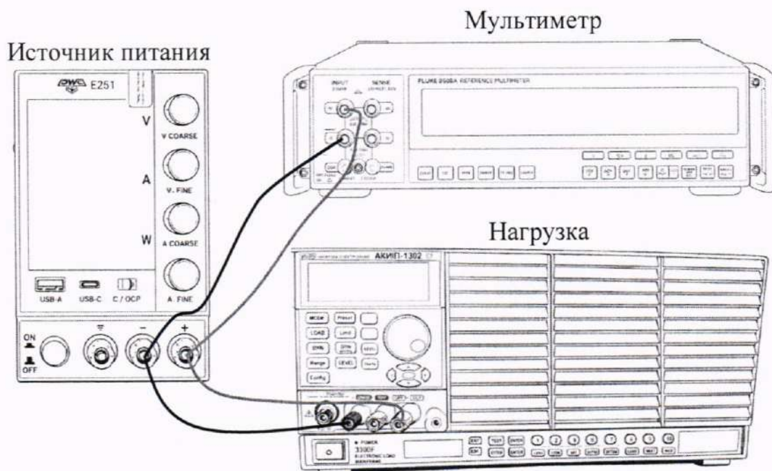
Рисунок 3 – Схема подключений для определения нестабильности напряжения постоянного тока на выходе при изменении тока нагрузки от 0,9 \cdot I_{\text{макс}} до 0,1 \cdot I_{\text{макс}}
