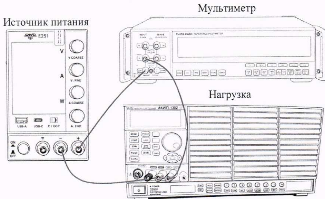
Рисунок 4 – Схема подключений для определения нестабильности силы постоянного тока на выходе при изменении напряжения на нагрузке от 0,75 \cdot U_{\text{макс}} до 0,1 \cdot U_{\text{макс}}
