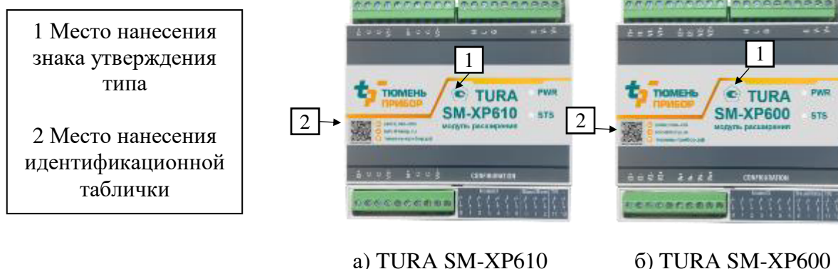
Рисунок 2 – Общий вид модулей расширения контроллеров с указанием места нанесения знака утверждения типа и идентификационной таблички
