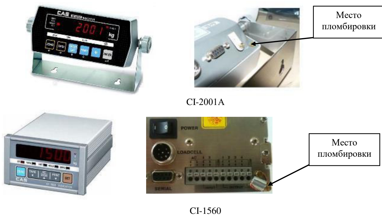
Рисунок 6 – Общий вид и место пломбировки приборов весоизмерительных от несанкционированного доступа
