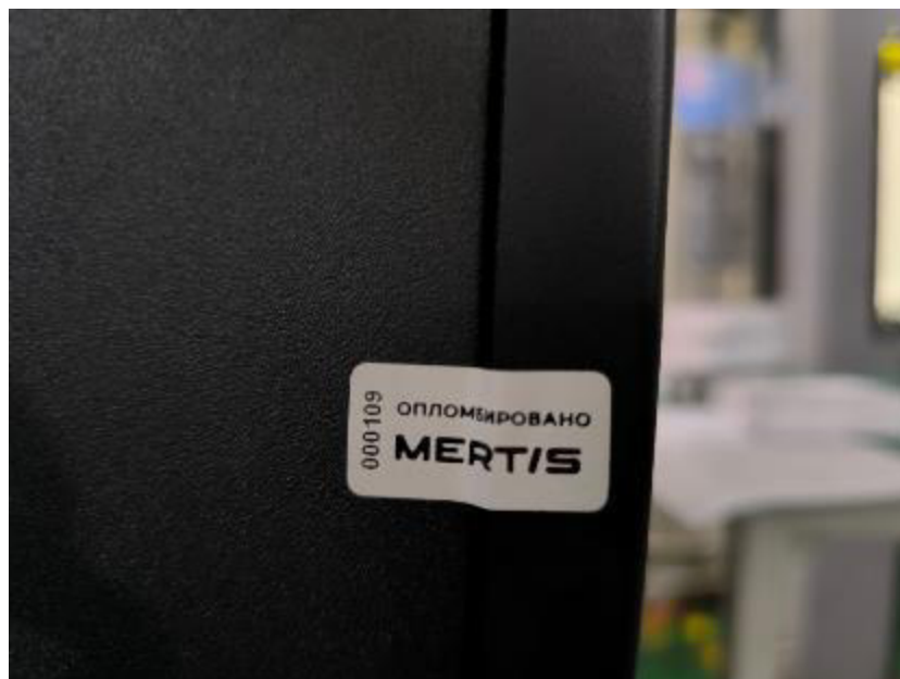
Рисунок 8 – Общий вид пломбировочной наклейки и место ее нанесения
