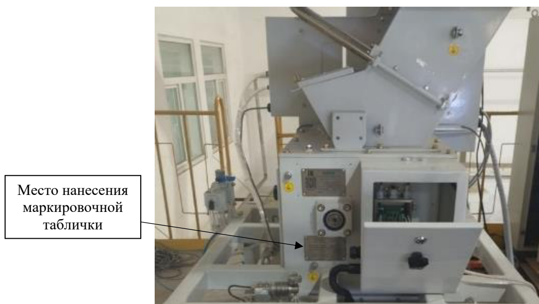
Рисунок 3 – Место нанесения маркировочной таблички со знаком утверждения типа и заводским номером
