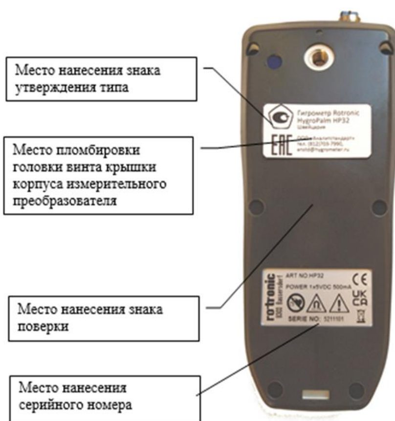
Рисунок 2 – Место нанесения знака поверки, серийного номера и пломбирования от несанкционированного доступа
