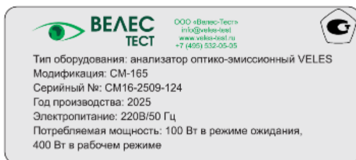
Рисунок 2 – Общий вид маркировочной таблички анализаторов опико-эмиссионных VELES
