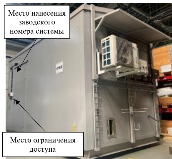
Рисунок 1 – Общий вид блок-контейнера системы
