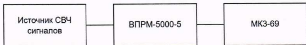
Рисунок 5 – Схема определения относительной погрешности непрерывных синусоидальных сигналов на нагрузку с КСВН ≤ 1,2 в режиме работы «НО-5»
