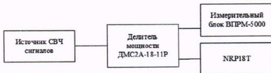
Рисунок 3 – Схема определения относительной погрешности непрерывных синусоидальных сигналов в режиме работы «Поверка» в диапазоне частот
