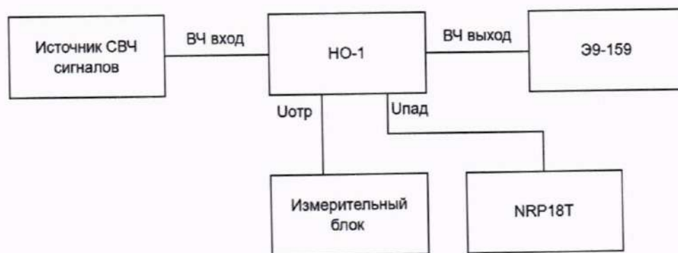
Рисунок 2 – Схема определения диапазона коэффициентов ответвления направленных ответвителей
