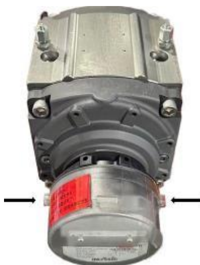
Рисунок 3 – Схема пломбировки от несанкционированного доступа и место нанесения знака поверки
