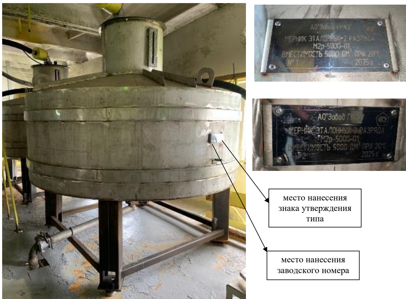
Рисунок 1. Фото общего вида мерников М2р-5000-01, место нанесения заводского номера и знака утверждения тип
