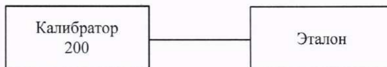
Рисунок 1 - Схема подключений для определения погрешности калибратора
