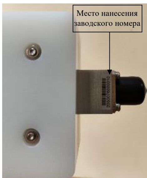
Рисунок 4 – Место нанесения заводского номера
