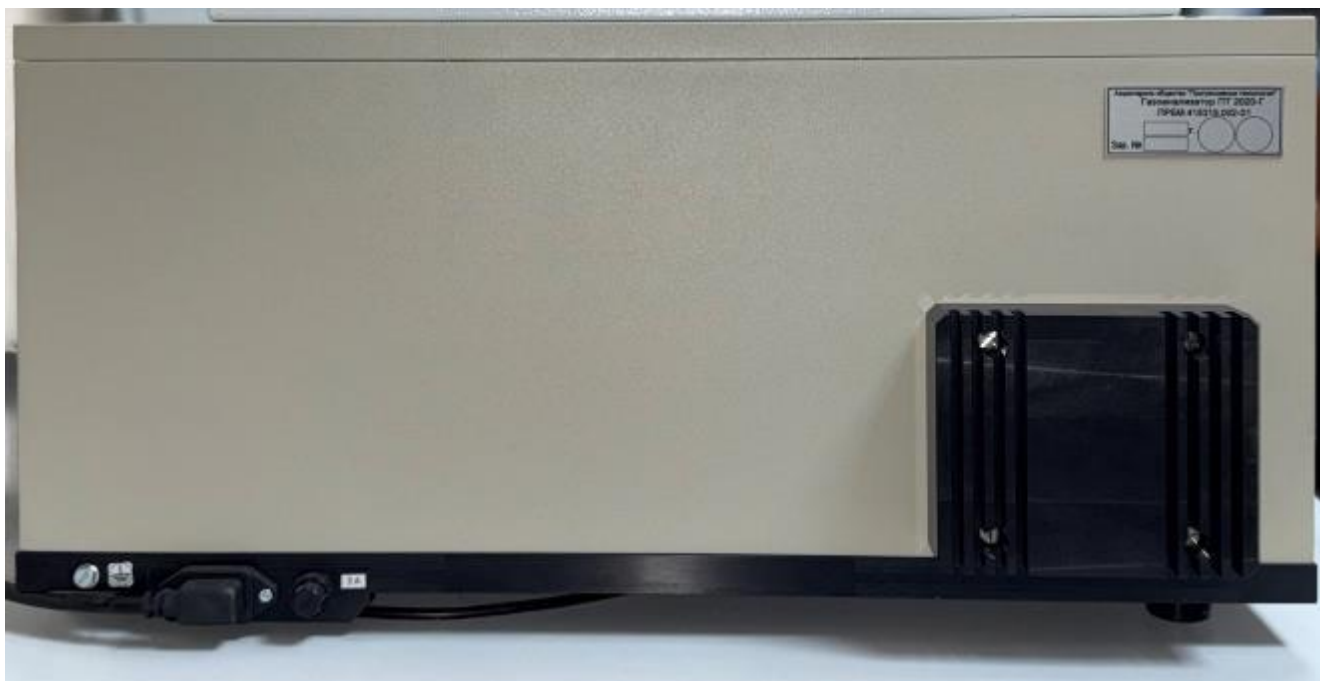
Рисунок 2 – Место установки маркировочной таблички газоанализатора
