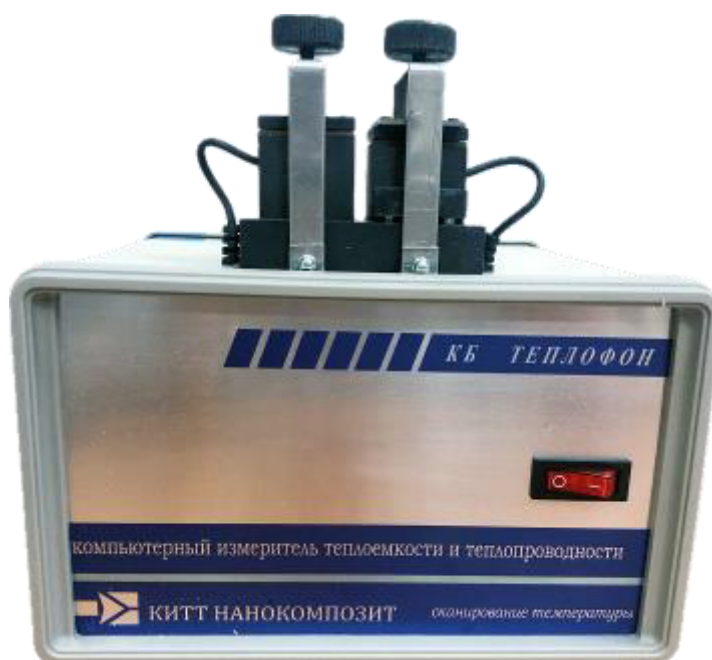
Рисунок 1 – Общий вид измерителя теплопроводности и теплоемкости компьютерного КИТТ НАНОКОМПОЗИТ
