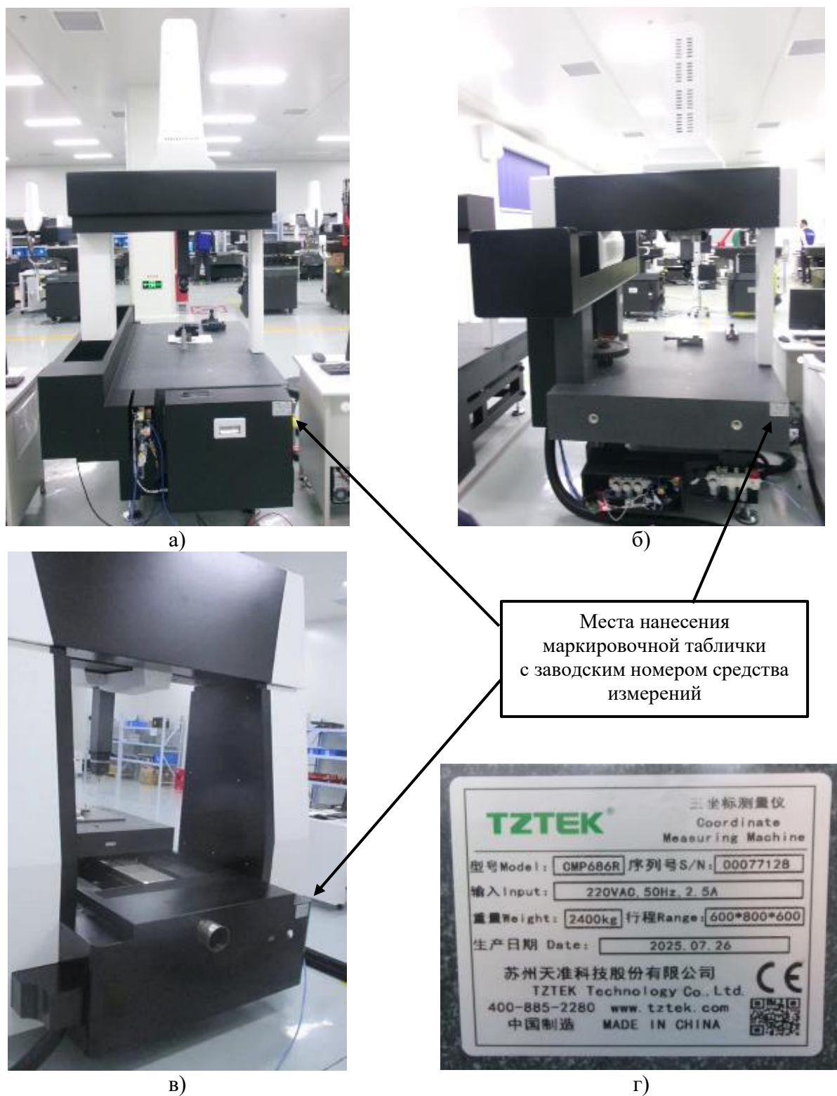
Рисунок 2 – Места нанесения маркировочной таблички с заводским номером средства измерений для модификаций: а) TZTEK CME; б) TZTEK CMP, TZTEK CMP Plus; в) TZTEK CMH; г) Общий вид маркировочной таблички с заводским номером средства измерений
