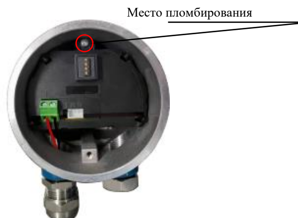
Рисунок 3 – Место нанесения защитной пломбы
