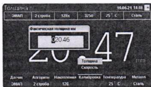
Рисунок 2 – Калибровка по известной толщине объекта контроля
