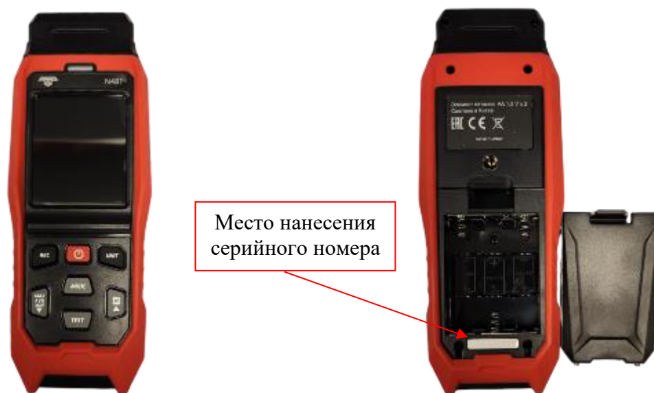
Рисунок 5 – Общий вид тахометров модификации АМО N481 с указанием места нанесения знака утверждения типа и места нанесения серийного номера
