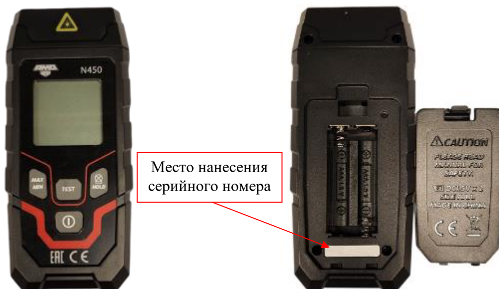
Рисунок 1 – Общий вид тахометров модификации АМО N450 с указанием места нанесения знака утверждения типа и места нанесения серийного номера
