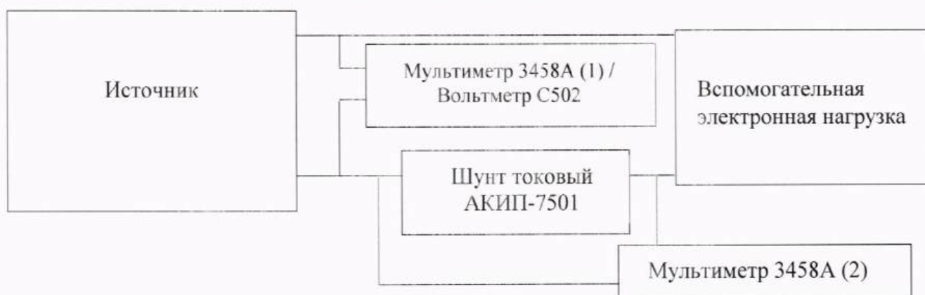
Рисунок 4 - Структурная схема определения нестабильности выходного напряжения постоянного тока, вызванной изменением силы тока в нагрузке, и нестабильности силы выходного тока, вызванной изменением напряжения на нагрузке
