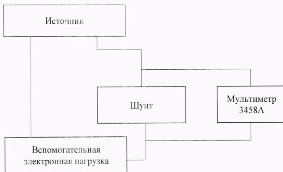
Рисунок 3 – Схема подключения источника при абсолютной (относительной) погрешности воспроизведений и измерений воспроизведенных значений силы постоянного тока
