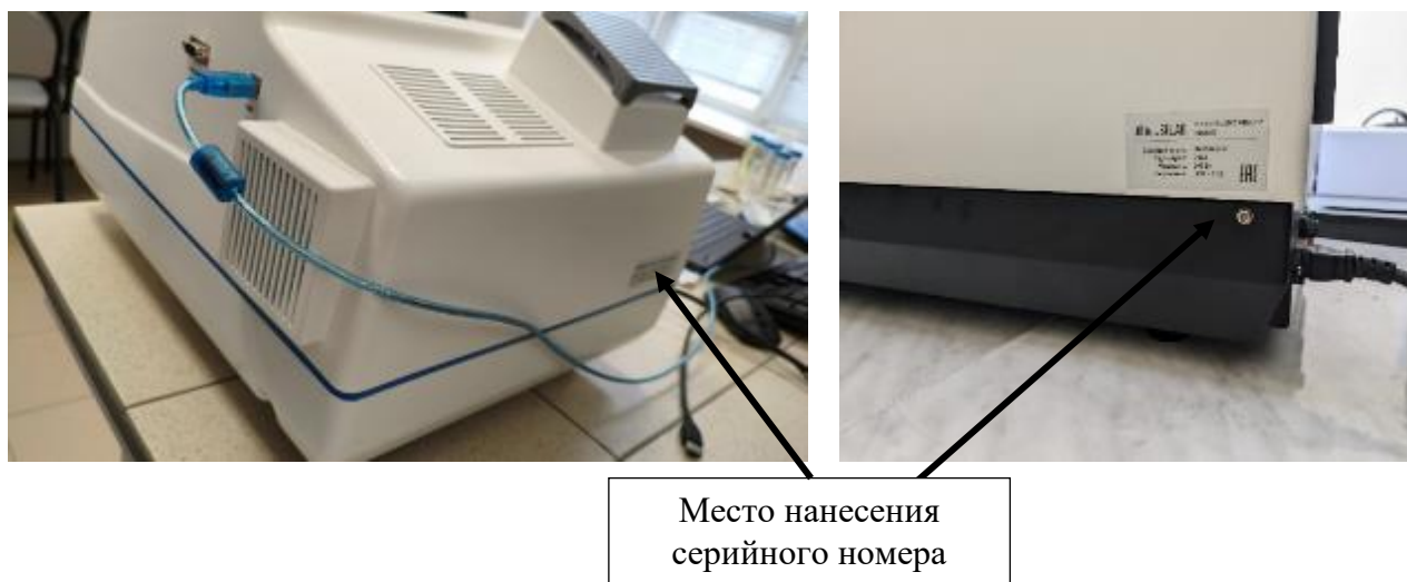
Рисунок 2 – Внешний вид (задняя панель) и схема маркировки спектрофлуориметров
